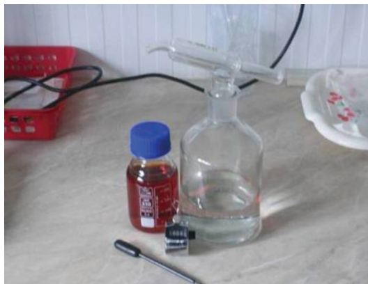
Εικόνα 26: Εξοπλισμός για την λήψη υπο-δειγμάτων και καταμέτρηση των Κωπηπόδων. Αριστερά διακρίνονται το διάλυμα Lugol , το σταγονόμετρο, ο καταμετρητής και η φιάλη δειγματοληψίας με την πιπέτα Witeg. Δεξιά πετρί τύπου μαιάνδρου από πλεξιγκλάς
