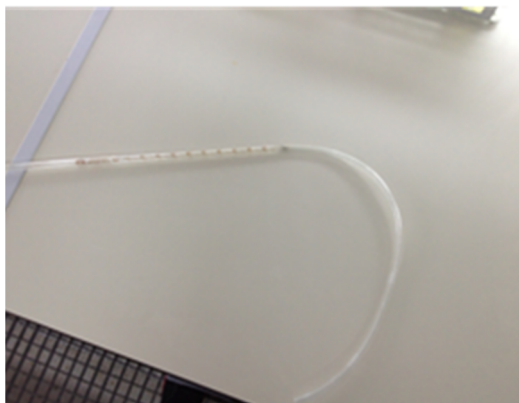
Εικόνα 7: Πιπέτα συνδεδεμένη με πλαστικό σωληνάκι για την παροχή αέρα στις καλλιέργειες. Αποσυνδέοντας προσωρινά τον εύκαμπτο πλαστικό σωλήνα από το δίκτυο αερισμού της αίθουσας, χρησιμοποιείται και ως σιφόνι για την λήψη δείγματος καλλιέργειας για μικροσκοπική παρατήρηση.
