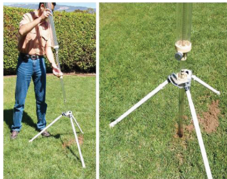
Εικόνα 4.9. Αριστερά: χαμήλωμα του GP μέσα στο τρίποδο και το φρεάτιο. Δεξιά: το GP σταθεροποιείται ωθώντας τον δακτύλιο του τρίποδου μέσα στη βάση του τρίποδου
