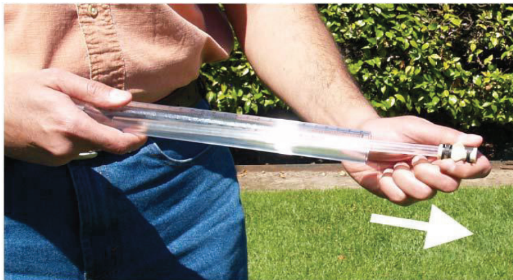
Εικόνα 4.10. Αφαίρεση του άνω αεροσωλήνα από το Well Head Scale
