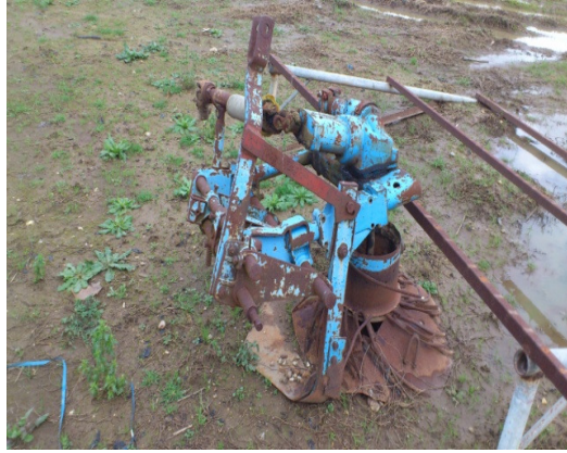
Εικόνα 19: Πατατοεξαγωγέας με τον οποίο έγινε η επιχωμάτωση του νάυλον
