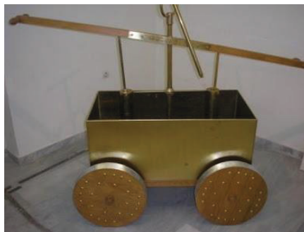
Εικόνα 4 Πυροσβεστική αντλία Ήρωνος
