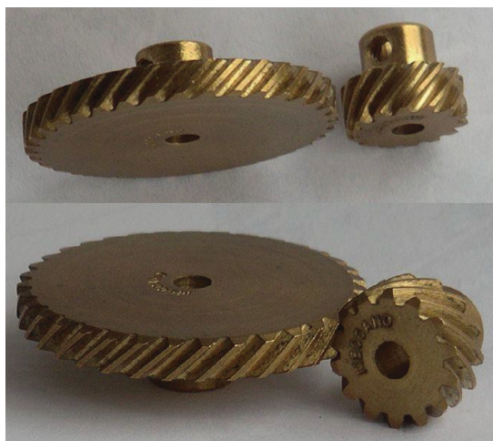
Εικόνα 3.4-2 : Εμπλοκή ελικοειδών γραναζιών
