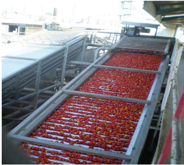
Εικόνα 3.3 Αναβατόρια (roller), μεταφορά τοματας προς δεξαμενές διανομής
