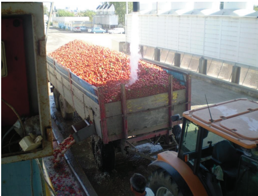
Εικόνα 3.1 Η παραλαβή της τομάτας στο εργοστάσιο
