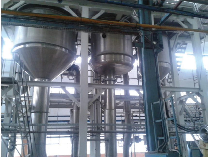
Εικόνα 3.14 Μοντέρνας τεχνολογίας συμπυκνωτής συνεχούς ροής και τριπλής ενέργειας
