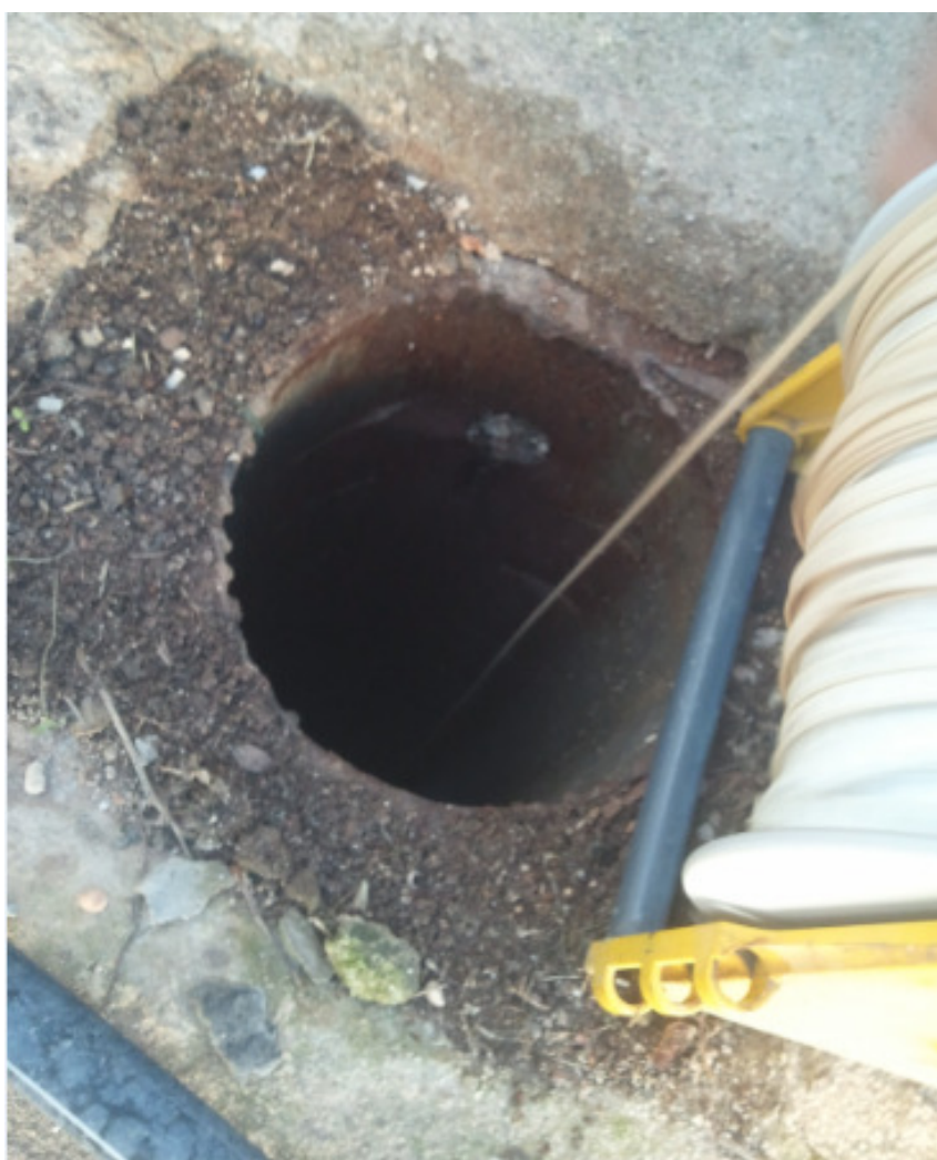
3.1) Μέτρηση στάθμης γέτρησης με χρήση σταθμήμετρου
