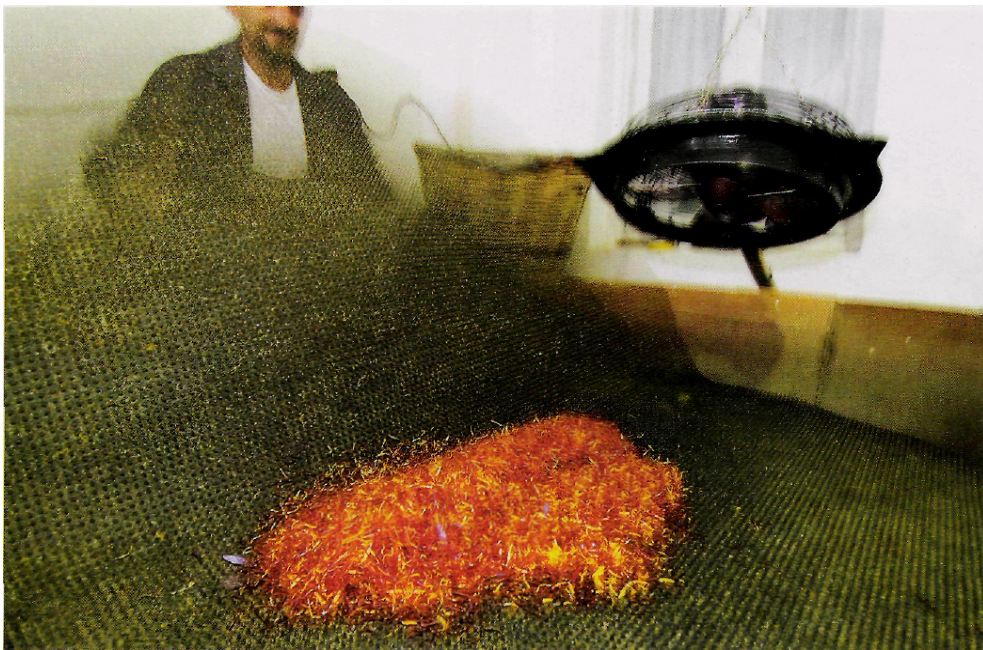
Εικόνα 14: Διαχωρισμός λουλουδιών - στημόνων με ειδικό ανεμιστήρα
