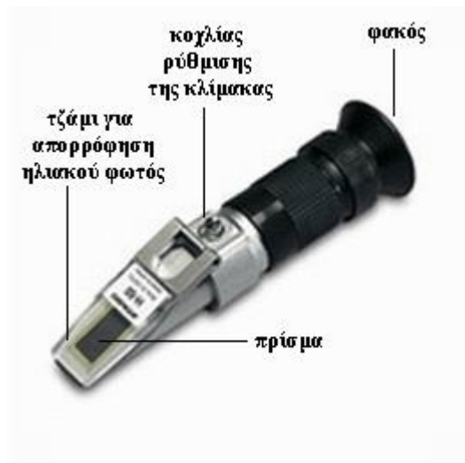
Εικόνα 3.9 Διαθλασίμετρο χειρός της εταιρίας ATAGO [ΠΗΓΗ: Από το Αρχείο του εργαστηρίου φυσιολογίας φυτών του Πανεπιστημίου Πατρών].
