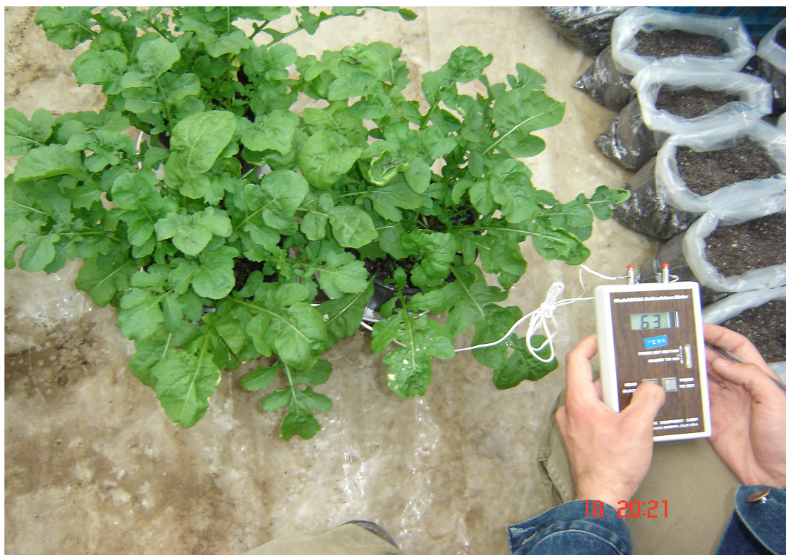
Εικ. 5.7.: Μέτρηση εδαφικής υγρασίας με την συσκευή βουγιούκος
