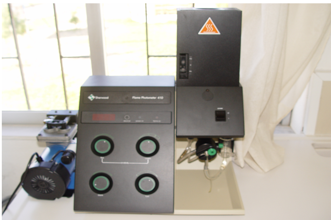
Εικ. 5.17.: Φλόγοφωτόμετρο (μέτρηση ασβεστίου, νατρίου και καλίου)
