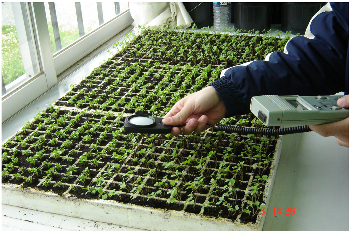
Εικ. 5.2.: Μέτρηση έντασης φωτισμού
