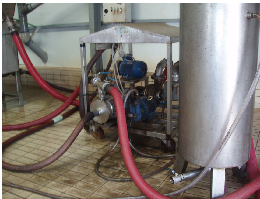
(Φώτο 7) Ειδικές αντλίες μεταφοράς ελαιοκάρπου μέσω ειδικού σπιδάλ.
