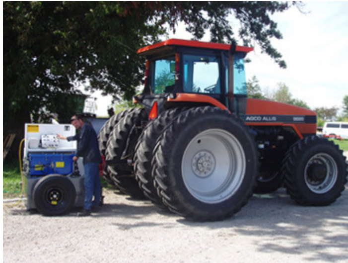
εικόνα 2 γ : μέτρηση της δύναμης ισχύος PTO
