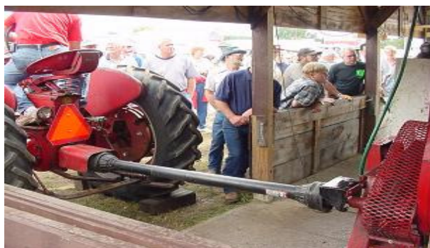
εικόνα 2 β : μέτρηση της δύναμης ισχύος PTO.
