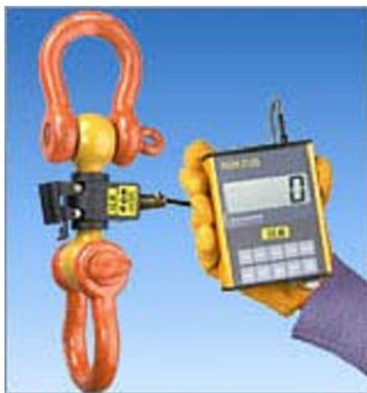
εικόνα 4 : δυναμόμετρο με ταινία μήκυνσης
