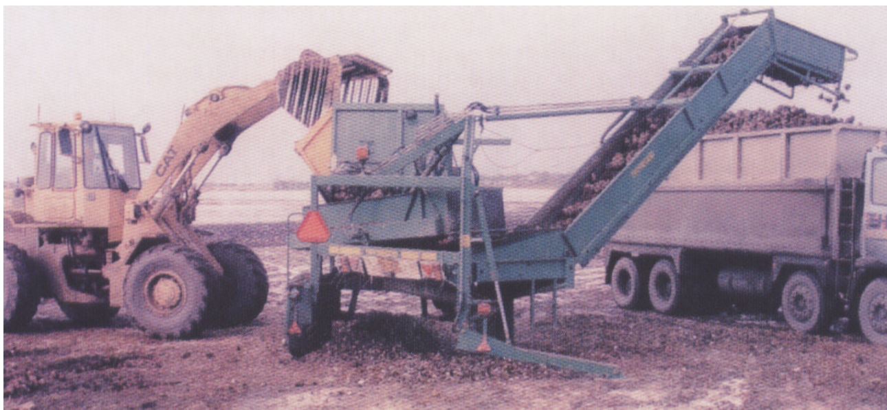
Συνδυασμός μηχανημάτων φόρτωσης – καθαρισμού.
