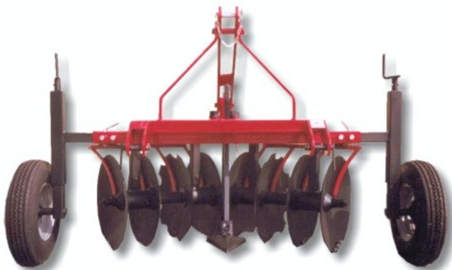
Εικόνα 40: Μηχάνημα για την ισοπέδωση αναχώματος
