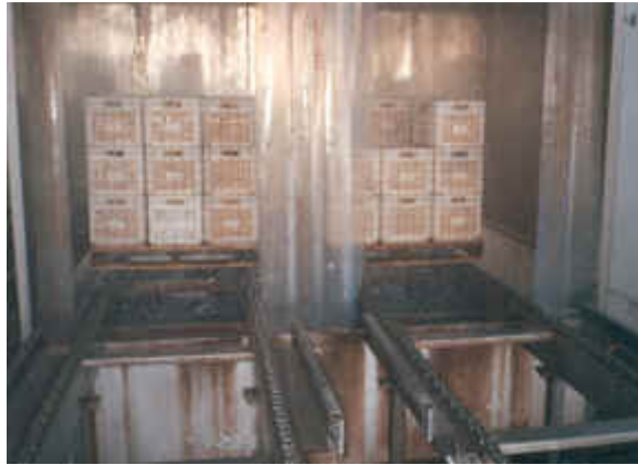
Εικόνα 46: Υδροκούλερ. Μηχάνημα ταχείας ψύξεως σπαραγγιών για καλύτερη και μεγαλύτερης διάρκειας συντήρηση των σπαραγγιών στα ψυγεία. Πρόκειται για ντους κρύου νερού 20 λεπτών, θερμοκρασία στην καρδιά των σπαραγγιών κατεβαίνει στους 3°C.
