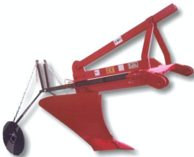
Εικόνα 36: Μηχάνημα για την κατασκευή αυλακιού για την φύτευση σπαραγγιού.
