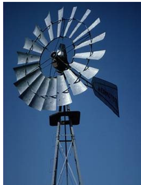
Γεωργικός Α/Κ στην Αριζόνα, που χρησιμοποιείται για άντληση νερού.
