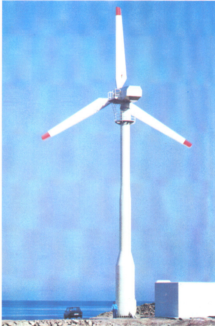
Ανεμοκινητήρας ονομαστικής ισχύος 150 KW (μεταβλητών στροφών), ελληνικής σχεδίασης και κατασκευής (Εργαστήριο Αεροδυναμικής Ε.Μ.Π.).
