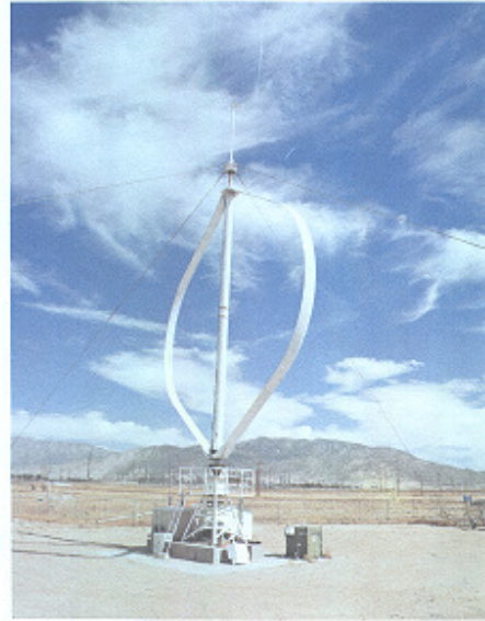
Ανεμογεννήτρια κατακόρυφου άξονα στο κέντρο δοκιμών Α/Κ για ΗΠΑ.
