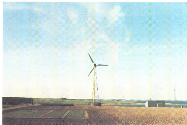
Οπτικοποίηση περιστρεφόμενου ομόρρου - Διαστολή ομόρρου (φωτογραφία Ι. Αντωνίου).
