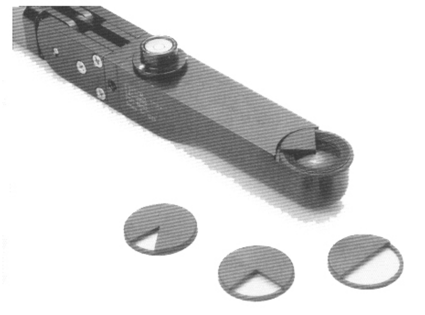
Εικόνα 1.8.3.2 Ο οπτικός αισθητήρας LAI-2050 με τους οπτικούς παρεμποδιστές. Όπως φαίνεται ο οπτικός παρεμποδιστής των 270° έχει εγκατασταθεί στον αισθητήρα. [2].
