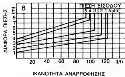
Εικ. 2.33.β Διάγραμμα ικανότητας αναρρόφησης σε σχέση με τη διαφορά πίεσης και την πίεση εισόδου (για αντλίες τύπου Venturi της Netafim ), διπλής φάσης.
