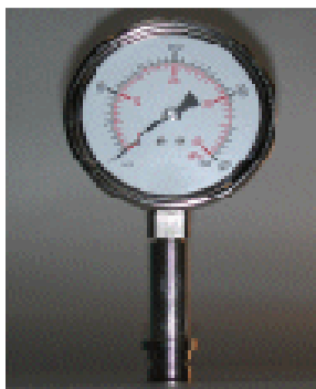
Σχήμα 6.20. Όργανα μέτρησης της πίεσης ενός ομοιογενοποιητή.
