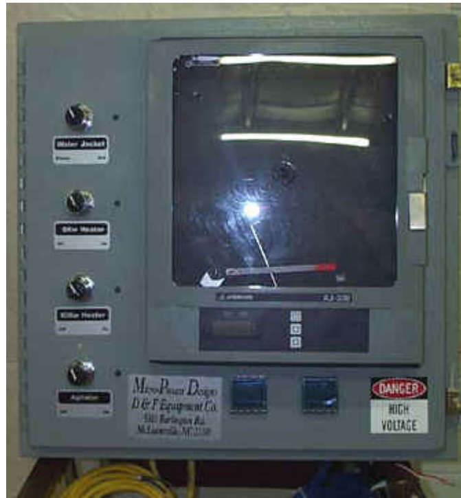
Σχήμα 6.5. Εικόνα ενός ηλεκτρικού καταγραφέα. Το μέγεθος είναι τέτοιό έτσι ώστε να προσαρμόζεται στην δεξαμενή.
