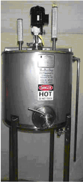
Σχήμα 6.3. Εικόνα ενός Μικροπαραγωγικού Παστεριωτή Μοντέλο 10/25 (Το Μοντέλο 10/50 είναι μονάδα 50 γαλονιών και είναι 7'' ψηλότερο από το κατώτερο σημείο ενός δεξαμενής).
