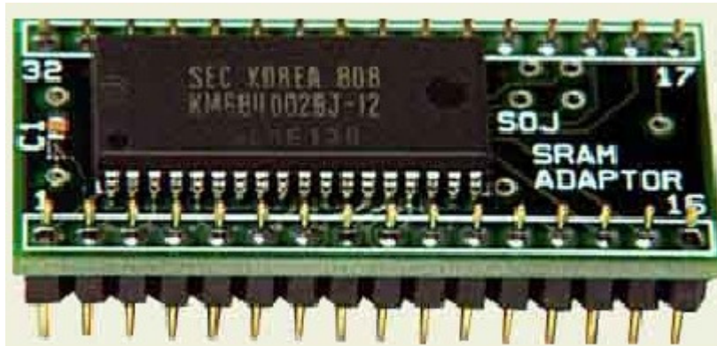
Εικόνα 2.3: Ένα chip στατικής μνήμης RAM (SRAM)
