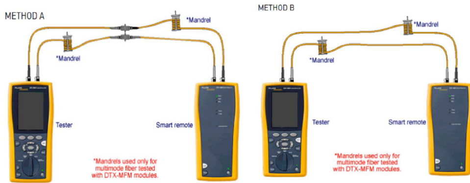
Σχήμα 2.5: Οι δύο βασικές μέθοδοι για τη βαθμονόμηση των συσκευών ελέγχου. Η μέθοδος A αν και υστερεί της μεθόδου B σε ακρίβεια προτιμάται από τους περισσότερους τεχνικούς.
