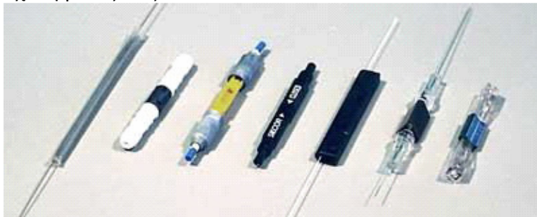
Σχήμα 3.12: Mechanical splicing tubes. Το πρώτο από τα αριστερά χρησιμοποιείται σε fusion splicing. Οι σωλήνες μηχανικής συγκόλλησης έχουν συνήθως και μια μικρή οπή για να μπορεί να διαφεύγει η περίσσεια κόλλας
