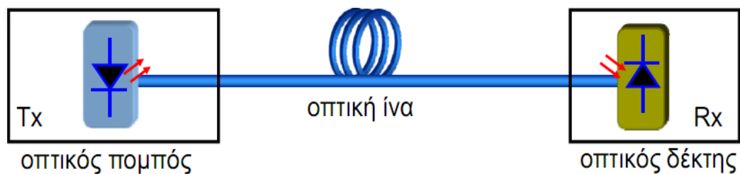
Εικόνα 8 Βασικό οπτικό τηλεπικοινωνιακό σύστημα (Ι. Βακίντης & Ε. Γυπάρης, 2011)
