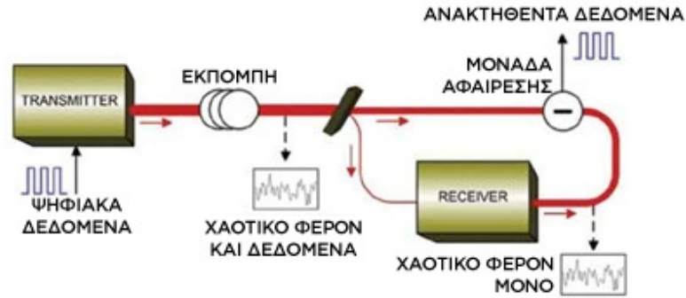
Σχήμα 3.8 Διάγραμμα χαστικής κρυπτογράφησης και αποκρυπτογράφησης του PICASSO
