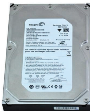
Εικόνα 3.6: Seagate 320GB SATA II (ST3320620AS)
