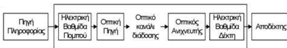
Εικόνα 5. Γενικό διάγραμμα βαθμίδων ασύρματου οπτικού συστήματος.
