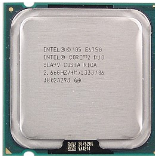
Εικ. 1: Πολυπύρηννος επεξεργαστής Intel Core 2 Duo E6750 δύο πυρήνων
