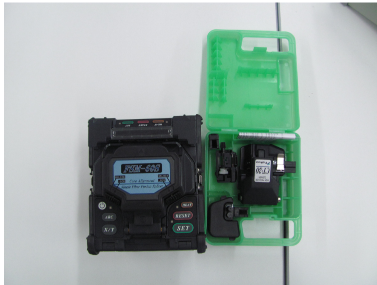
Σχήμα 2.1.1 Splicer, όργανο συγκόλλησης οπτικών ινών
