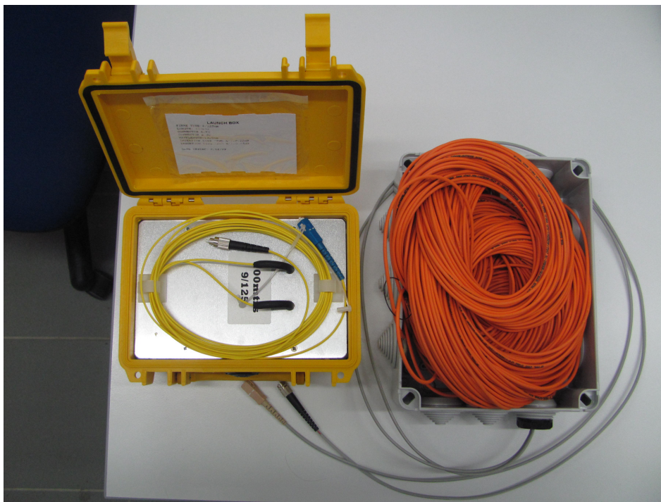
Σχήμα 1.4. Μονότροπη και πολύτροπη οπτική ίνα
