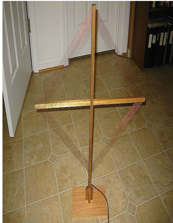
Figure 11 Κεραία βρόγχου ρομβικού σχήματος
