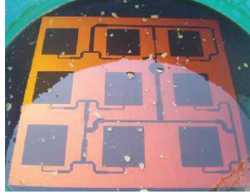
Figure 25 Εσωτερικό ασύρματης κεραίας Panel
