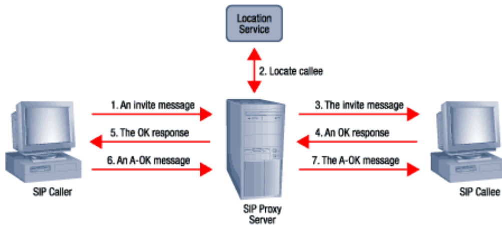
Εικόνα 35: Χρήση διακομιστή μεσολάβησης και υπηρεσίας εντοπισμού στο SIP
