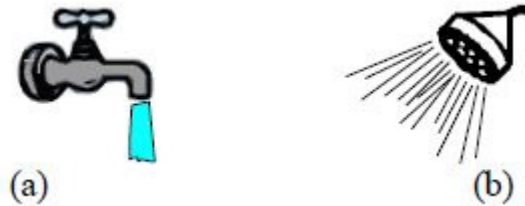
Σχήμα 15. (α) ένας κανονικός ενιαίος μεταφορέας -FDM – ολόκληρη μια δέσμη του νερού που έρχεται όλη σε ένα ρεύμα. (β) ορθογώνιος-FDM – ίδια ποσότητα του νερού που προέρχεται από πολλά μικρά ρεύματα.
